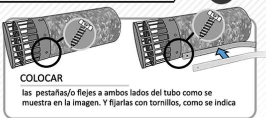
COLOCAR las pestañas/o flejes a ambos lados del tubo como se muestra en la imagen. Y fijarlas con tornillos, como se indica
