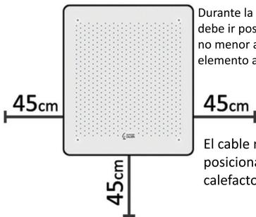
Durante la instalación el calefactor debe ir posicionado a una distancia no menor a 45cm de cualquier otro elemento ajeno a la pared misma.
